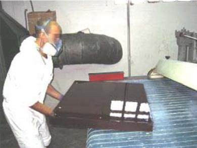
Figura 2. Operario separando piezas barnizadas mediante cortina
