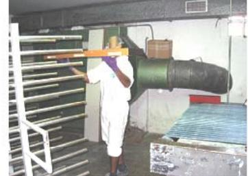
Figura 4. Operario depositando piezas barnizadas mediante cortina
