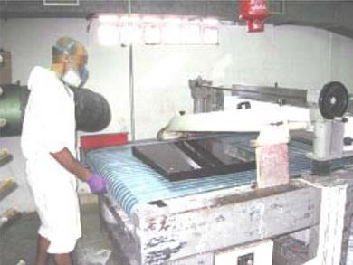
Figura 3. Operario recogiendo piezas barnizadas mediante cortina
