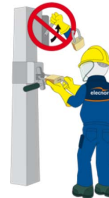
1. Desconectar todas las posibles fuentes de tensión
