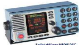
Radioteléfono MF/HF DSC
