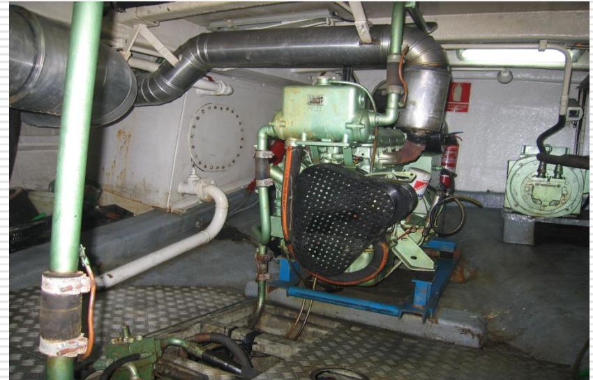
Protección de elementos rotativos y superficies calientes
