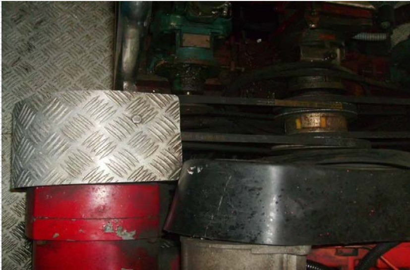
Protección de elementos rotativos y superficies calientes
