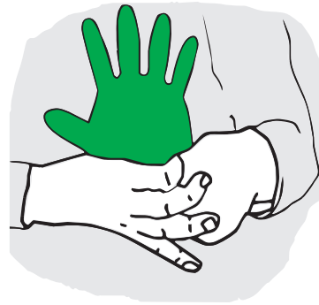
Figura 4. Comprobación de la ausencia de fugas.
