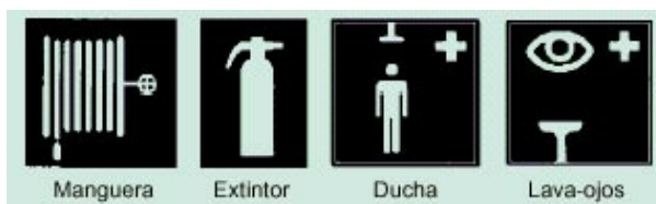
Fig. 6: Señalización de los elementos de actuación
