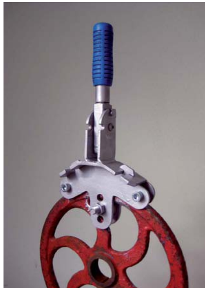
Fig. 11 y 12 La llave Antropométrica fija con el manubrio en posición radial.
