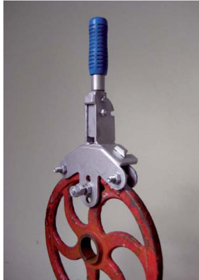
Fig. 9 y 10 La llave Antropométrica fija con el manubrio en posición axial.
