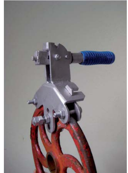
Fig. 9 y 10 La llave Antropométrica fija con el manubrio en posición axial.
