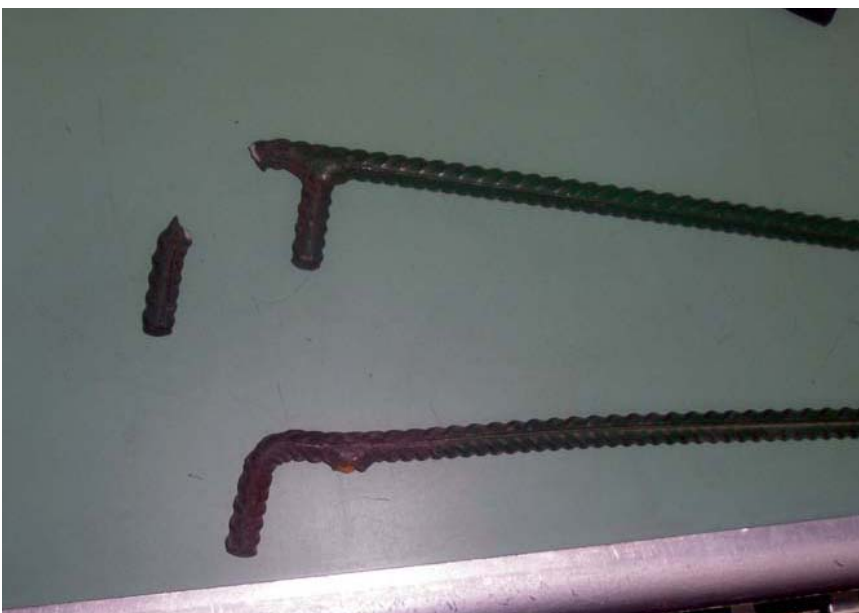
Fig. 3 Útiles rotos por sobreesfuerzos.
