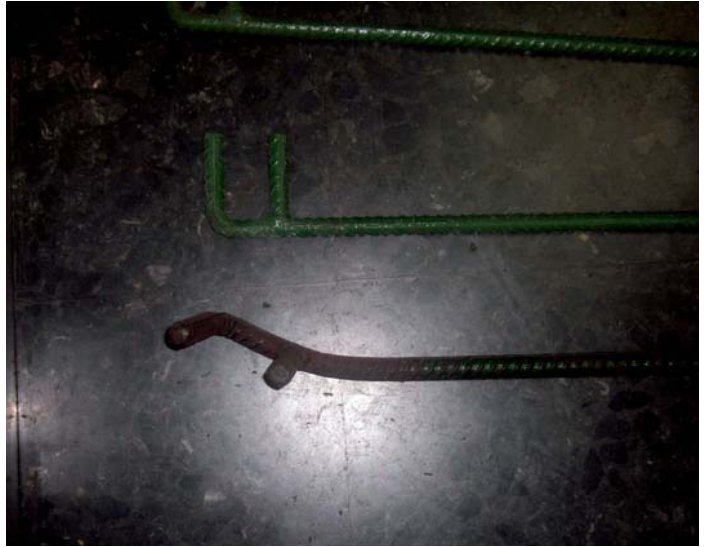
Fig. 2 Útil doblado por efecto de la fatiga.
