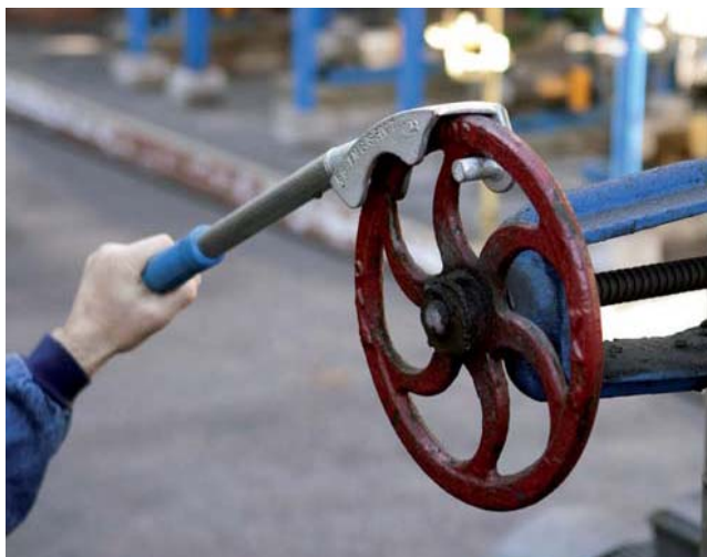
Fig. 7 y 8 La llave facilita de forma evidente la maniobra de las válvulas horizontales y verticales.
