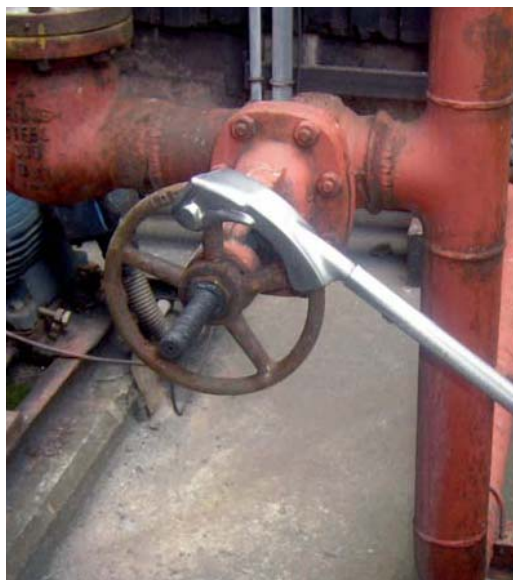
Fig.5 Llave prototipo en prueba.
