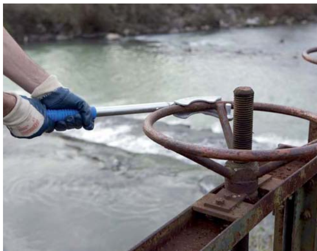
Fig. 7 y 8 La llave facilita de forma evidente la maniobra de las válvulas horizontales y verticales.
