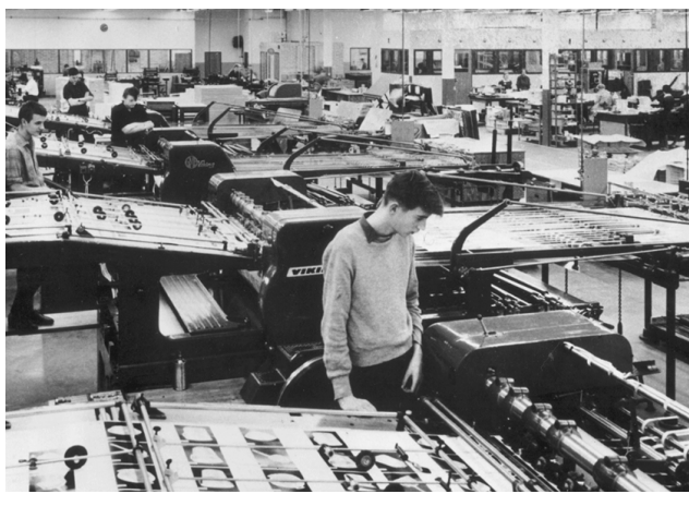
Figura 85.1 • Operaciones finales del proceso de impresión; el material impreso que sale de la rotativa se corta y se le da la forma del producto definitivo.
