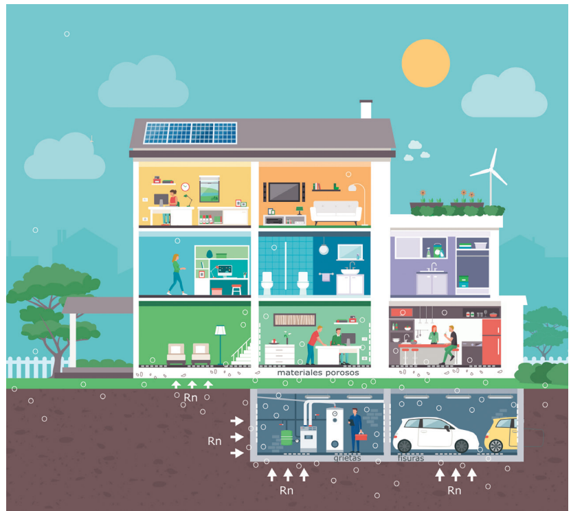
■ Figura 3 ■ Penetración del radón en los edificios
