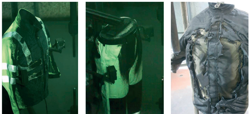
Imagen 9 Diferentes prendas sometidas a un ensayo de arco abierto
