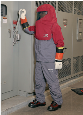
■ Imagen 10 ■ Chaqueta y pantalón con protección frente al arco eléctrico, con ATPV: 20 cal/cm². Método de ensayo de la norma UNE-EN IEC 61482-1-1
