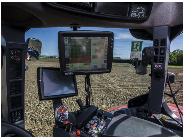
Figura 4. Vista del interior de la cabina de un tractor agrícola dotado de asistencia digital
