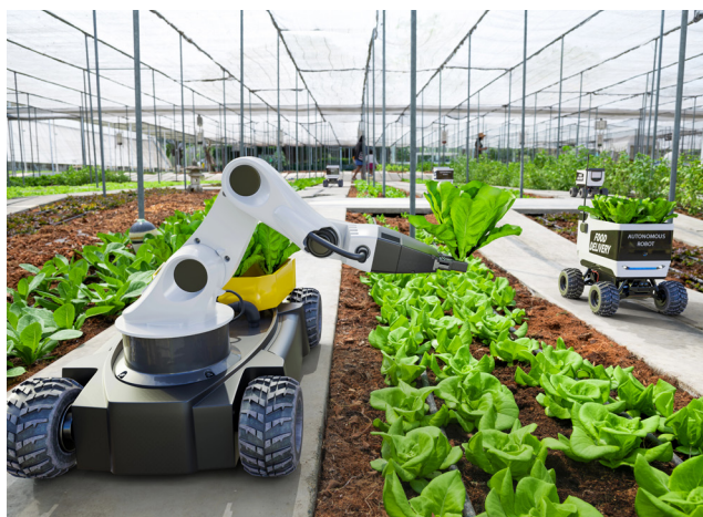
Figura 7. Brazo robótico sobre plataforma móvil y robot de transporte, que reduce carga física en recolección
