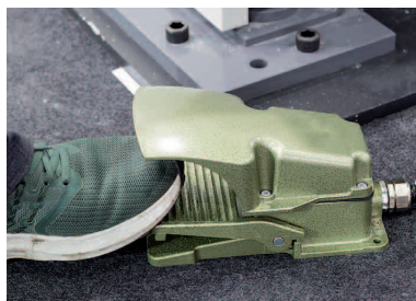
■ Figura 11 ■ Pedales que se pueden colocar libremente bajo la mesa [9] [10]
