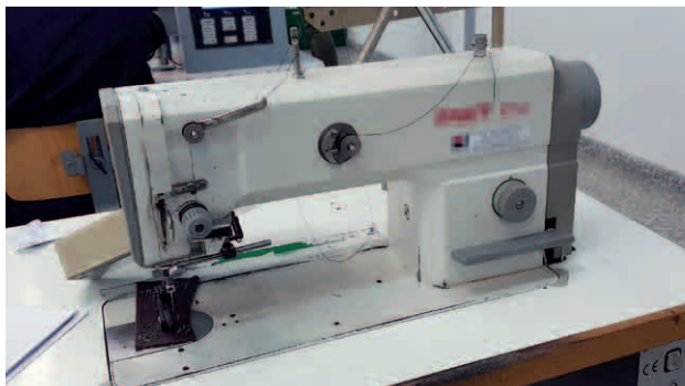
■ Figura 6 ■ Máquinas de apurado planas y de columna
