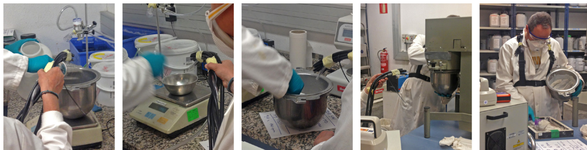
Figura 1. Tareas realizadas en los ensayos: (T1- Pesar mortero), (T2- Pesar \text{TiO}_2 nanométrico), (T3- Mezclar materiales en seco), (T4- Amasar con agua) y (T5- Moldear).
